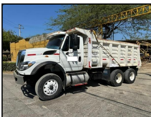
Ilustración 8. Volqueta Doble-Troque. Fuente: SALDU.
