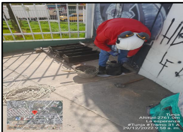
Figura 30. Ensayo de vigas y cono
