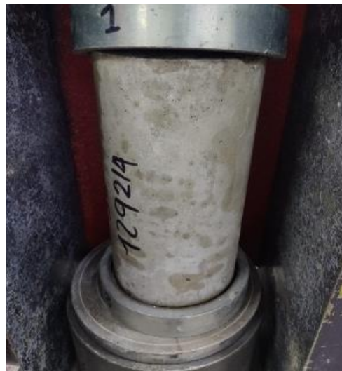
Ilustración 8. espécimen de falla tipo 5, Elaboración propia
