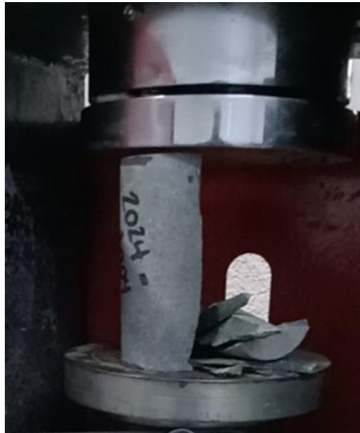
Ilustración 9. Núcleo de concreto, Elaboración propia
