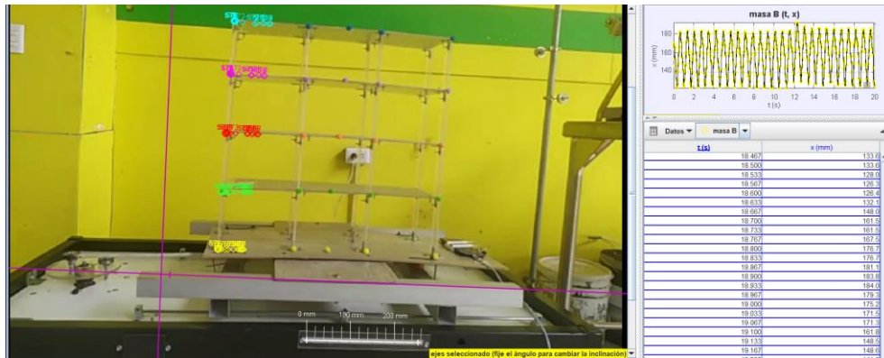
Ilustración 42 Interfaz Tracker ensayo dinámico 10m/s 2
