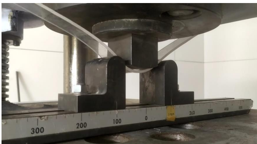
Ilustración 49 Ensayo de flexión al material
