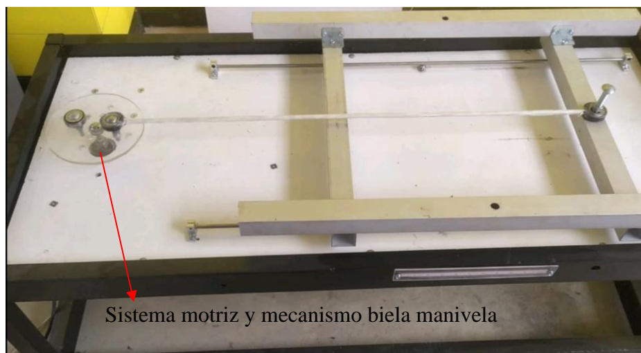
Ilustración 19 Mecanismo biela manivela en prototipo
