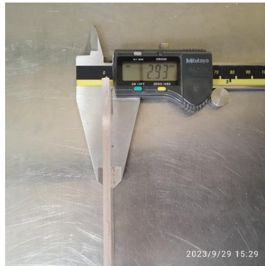
Ilustración 28 Espesor aproximado del acrílico
