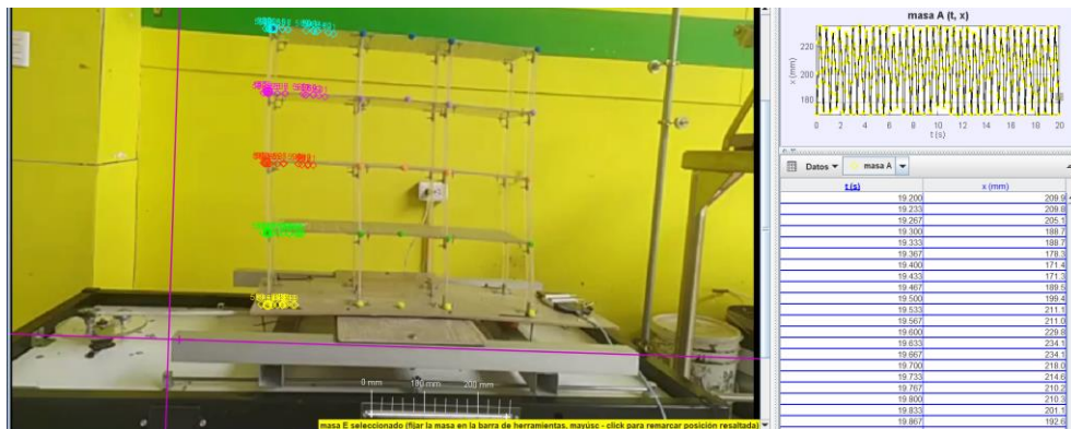
Ilustración 43 Interfaz Tracker ensayo dinámico 15m/s 2
