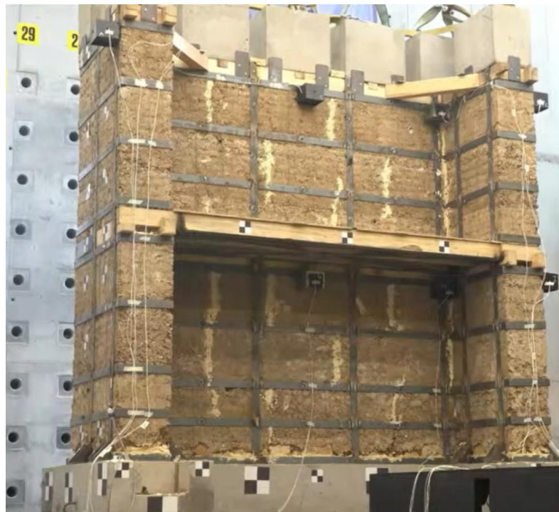
Ilustración 2 Ensayo en mesa vibratoria a modelo 1:2 de estructura en tapia
